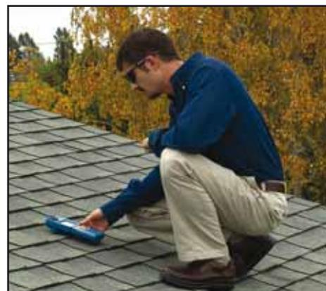
Un inclinomètre est désormais intégré au SunEye 210. Posez-le simplement sur le toit et lisez la direction et l'inclinaison.
