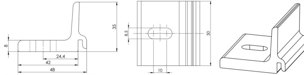
**La nouvelle version :** laquelle est subdivisée en plusieurs versions de Climbers selon le diamètre de la vis (36/50 RoofHook avec diamètre M8 – 36/50 avec diamètre M10 et 36/50 avec diamètre M12)
