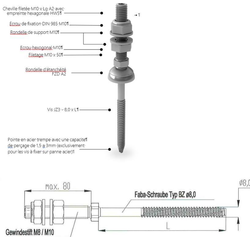
La vis à double filetage est disponible en différentes longueurs et différents diamètres. Elle est adaptée pour les toitures en fibrociment à profil ondulé et ossature porteuse en acier (S235). L'étanchéité de la couverture est assurée par un joint FZD.
