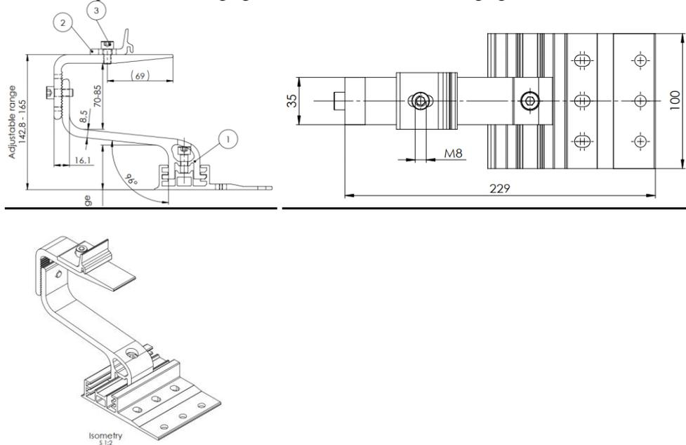
*Ce qui différencie la nouvelle version de l'ancienne, c'est le mode d'accroche de l'équerre sur la patte : dans la nouvelle version, une vis est utilisée en lieu et place d'un boulonnage
