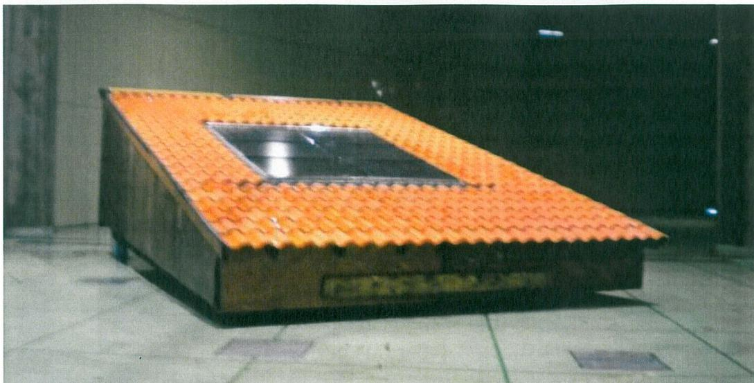
**Figure 14 : Pente de 15° - Incidence du vent 30° - Rampant 8,20 m**
