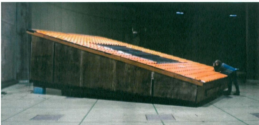
**Figure 15 : Pente de 15° - Incidence du vent 60° - Rampant 8,20 m**
