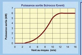
L'aérogénérateur Scirocco est caractérisé par un rendement très élevé, et particulièrement dans la gamme de vitesses de vent faible à modéré, ce qui représente 80% du temps de fonctionnement en pratique.
