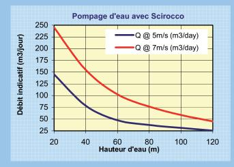
Pour les applications de pompage d'eau au fil du vent, Scirocco établie de nouveau standard avec son concept de pompage direct couplé à une recherche de point de fonctionnement optimal.
