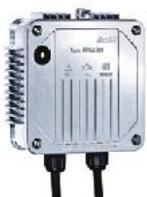
élevé d'interconnexions de chaîne et du nombre réduit de câblages. L'adoption d'une boîte de jonction innovante à ailettes moulée sous pression, en plus de refroidir efficacement les diodes si elles ont à intervenir, permet d'éliminer la chaleur des cellules correspondant à sa surface de contact avec le panneau arrière en augmentant donc le rendu énergétique du module.
