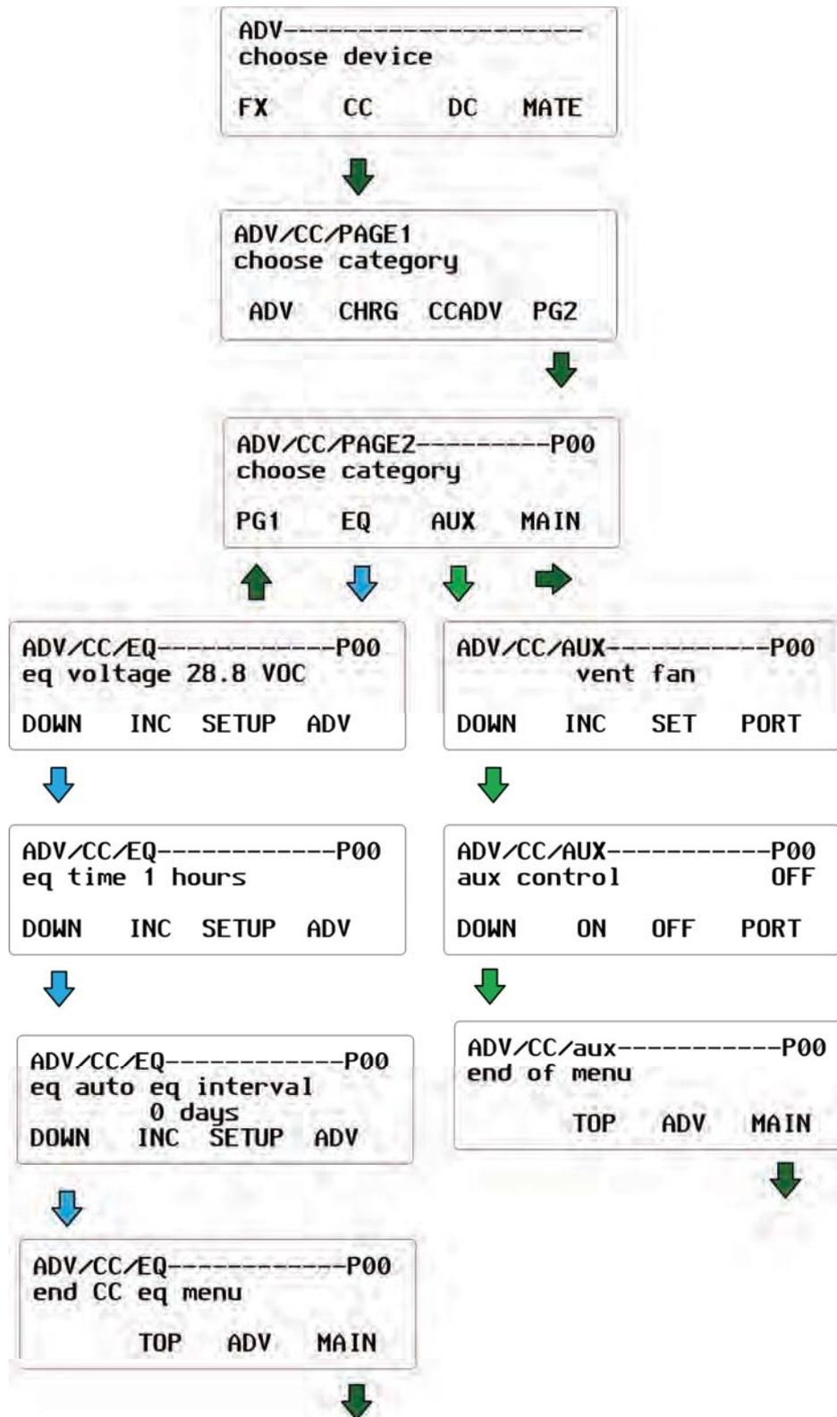
Figure 99 Schéma des menus ADV CC Setup (Page 2)
