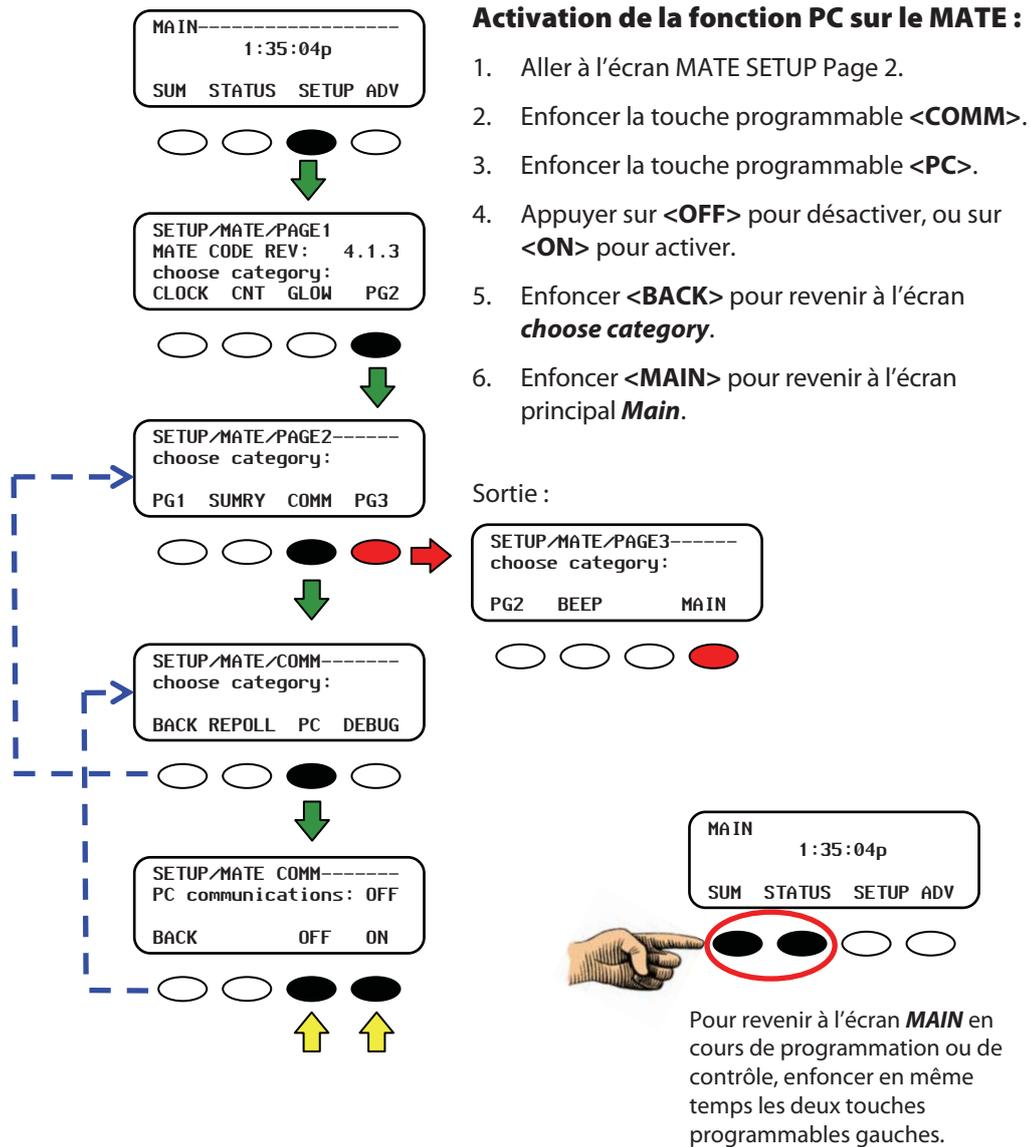
**Figure 27 Activation de la connexion PC sur le MATE**
