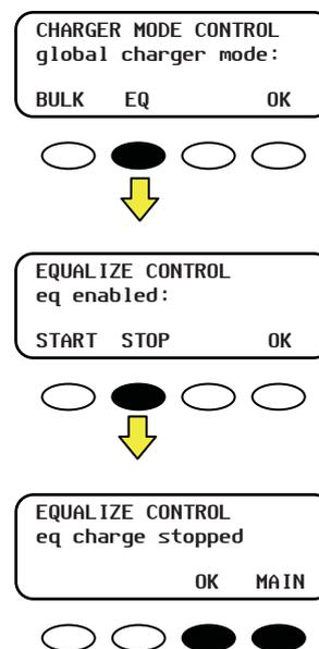
Figure 14 Arrêt d'une charge d'égalisation
