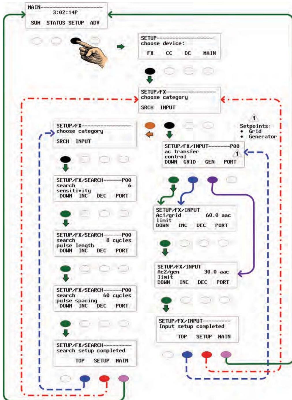
Figure 46 Configuration de base de l'onduleur FX
