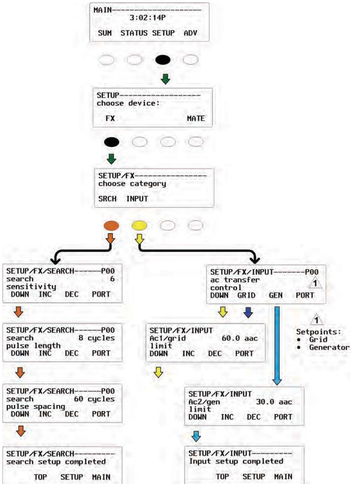
Figure 93 Schéma des menus FX SETUP
