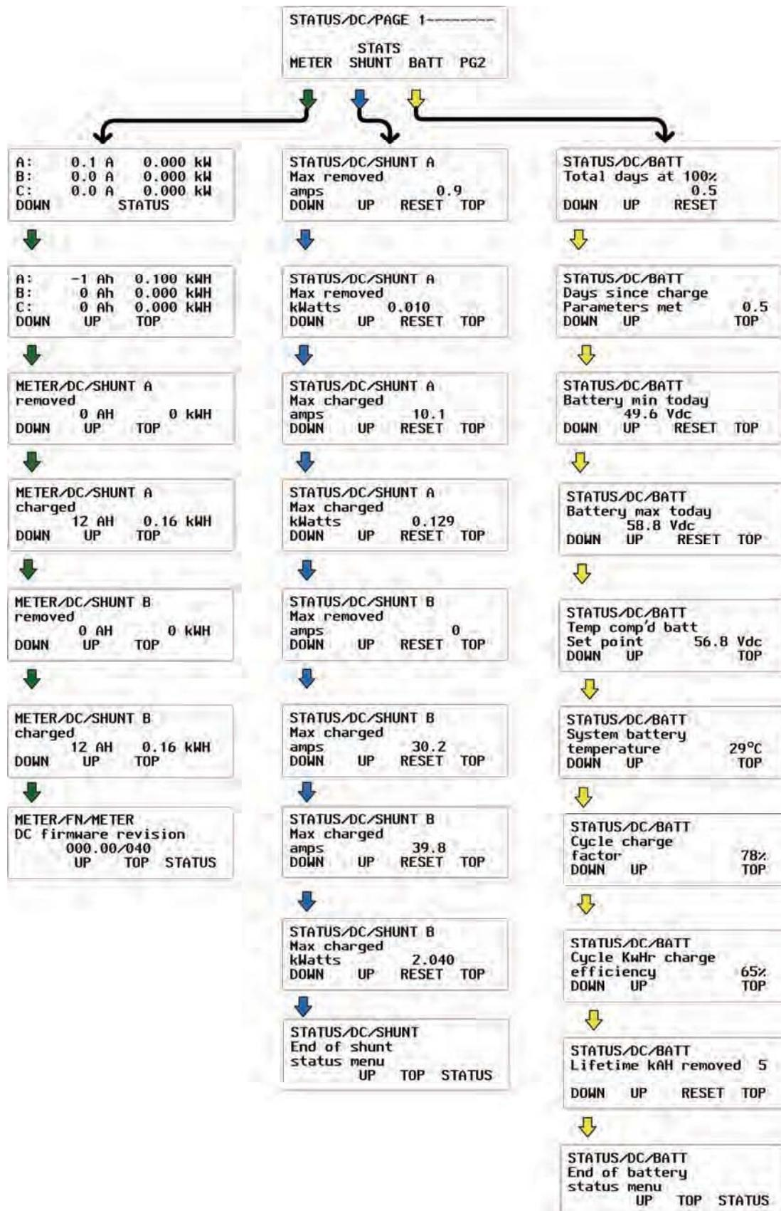
Figure 85 Schéma des menus FLEXnet DC (FNDC) STATUS Menu Map
