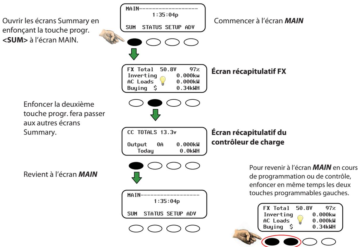
**Figure 28** Écrans Summary MATE (avec un contrôleur de charge FLEXmax)
