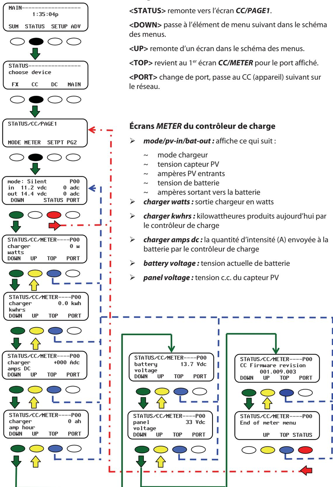
Figure 39 Écrans METER du contrôleur de charge
