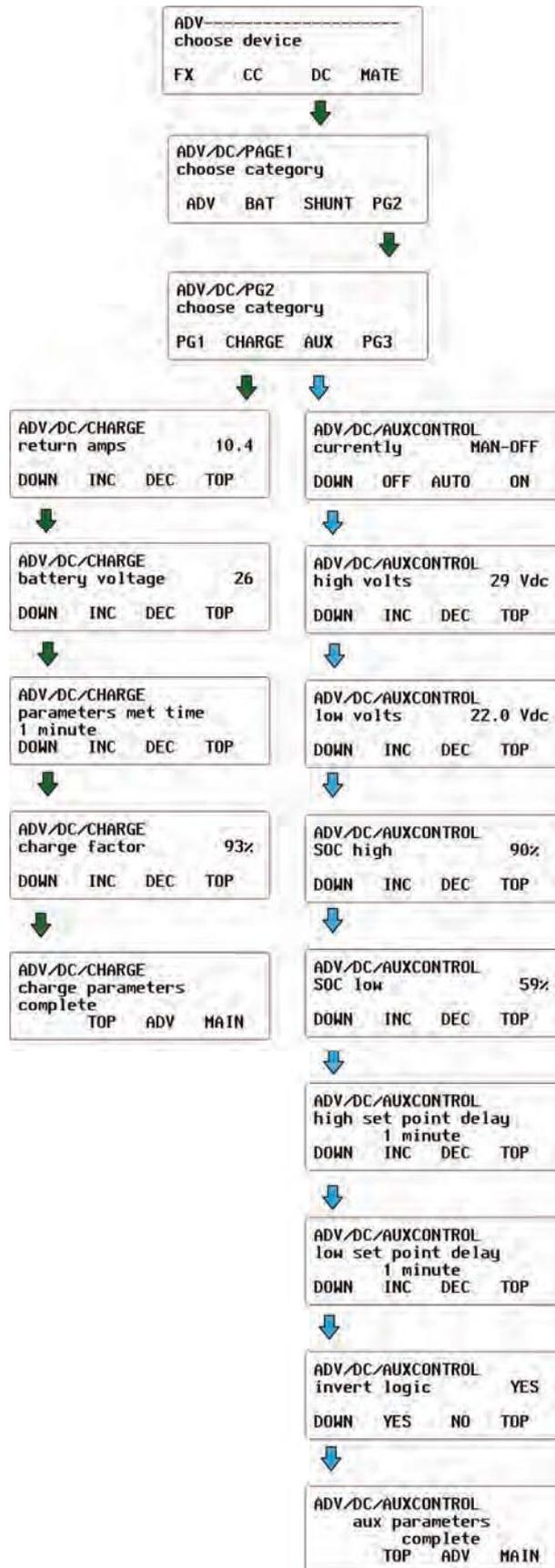
Figure 101 Schéma des menus ADV FNDC Setup (Page 2)
