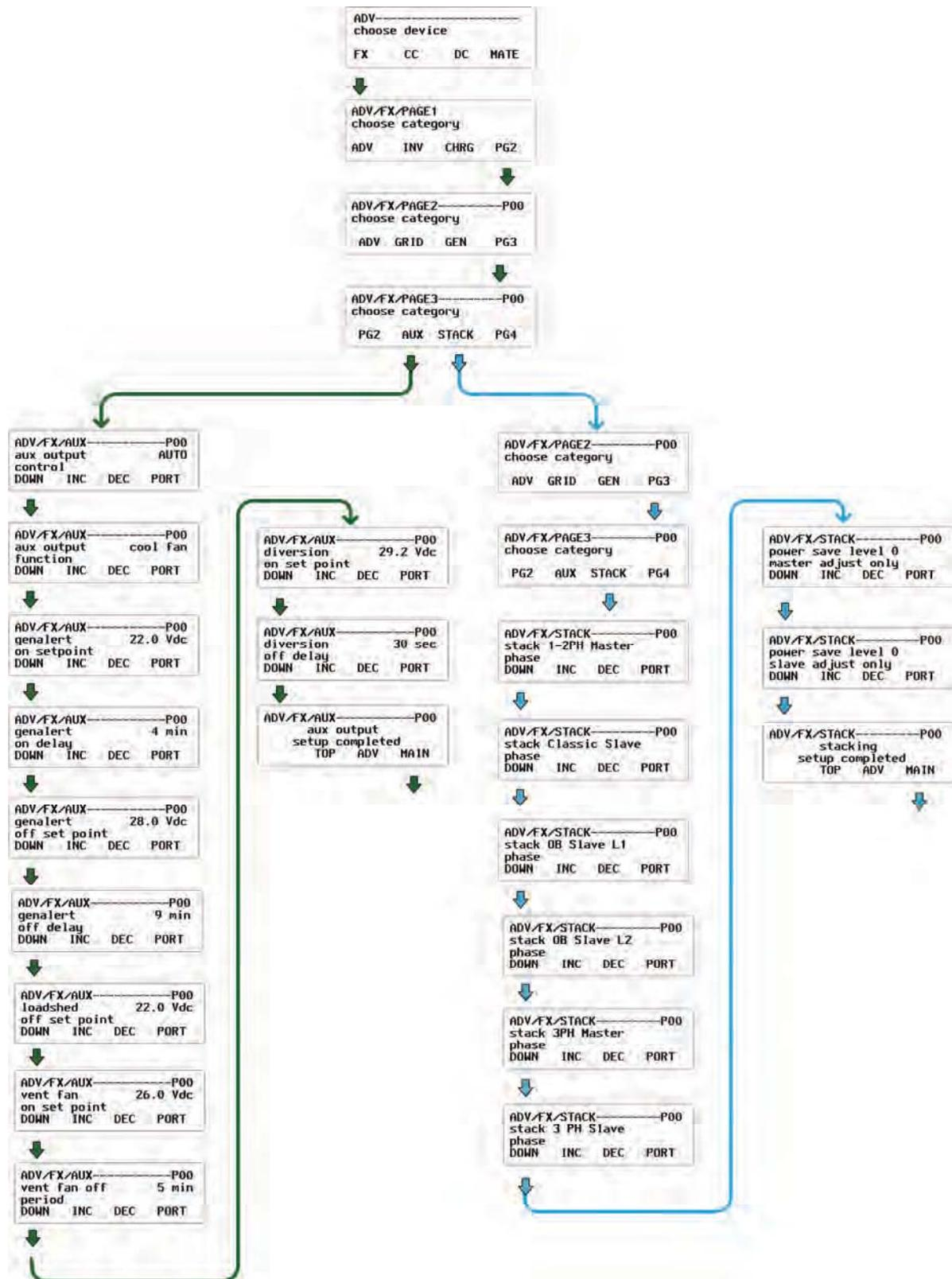
Figure 96 Schéma des menus ADV FX Setup (Page 3)
