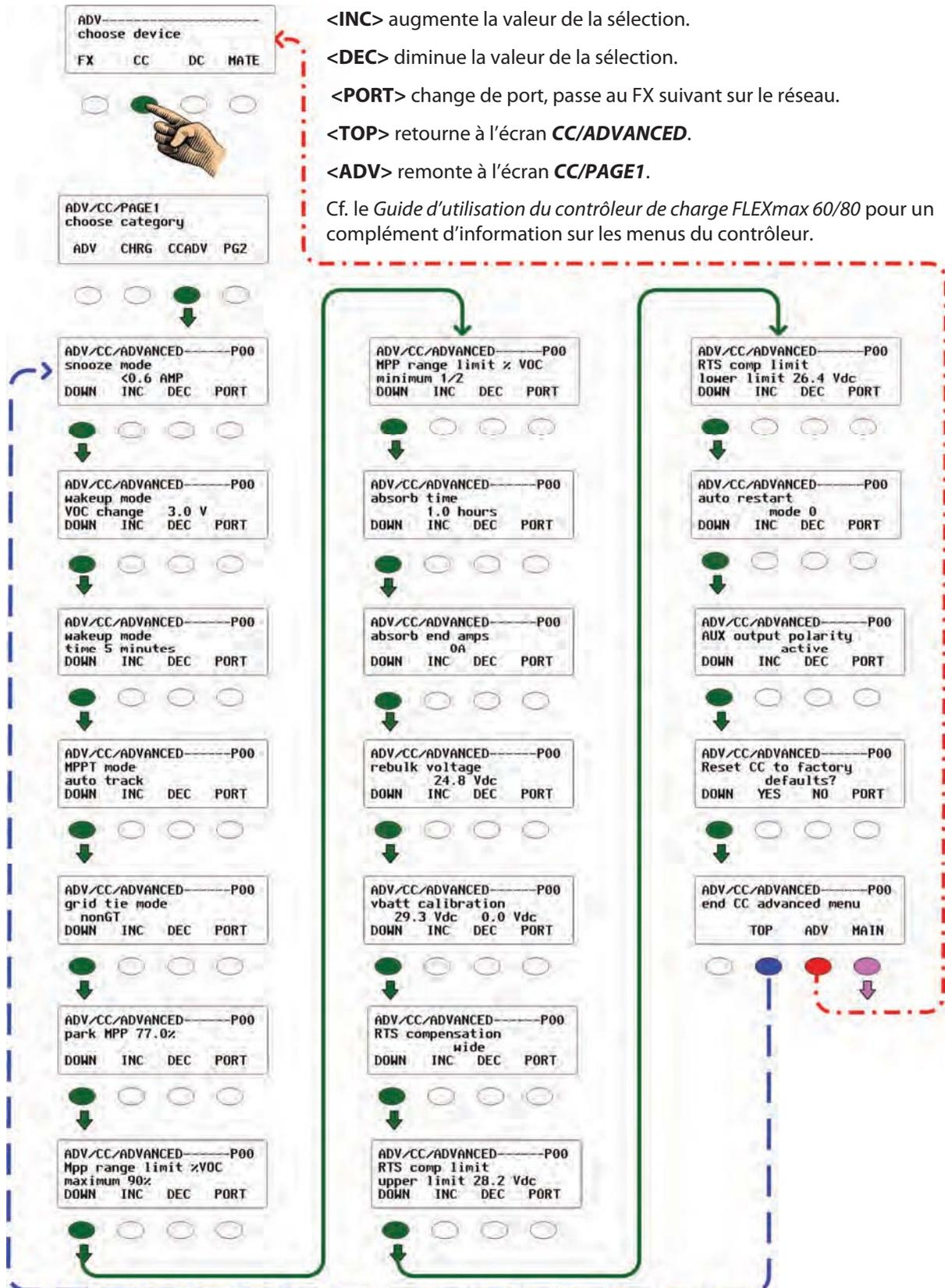
Figure 71 Menu ADV des fonctions avancées de charge du contrôleur
