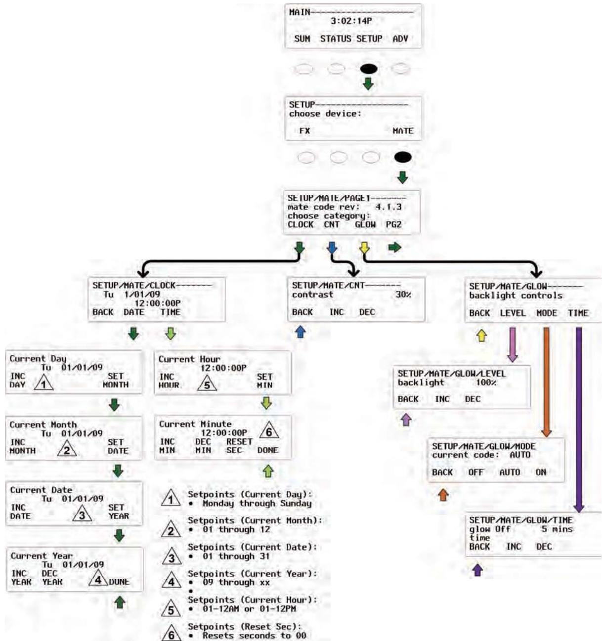
**Figure 86 Schéma des menus MATE SETUP (Page 1)**
