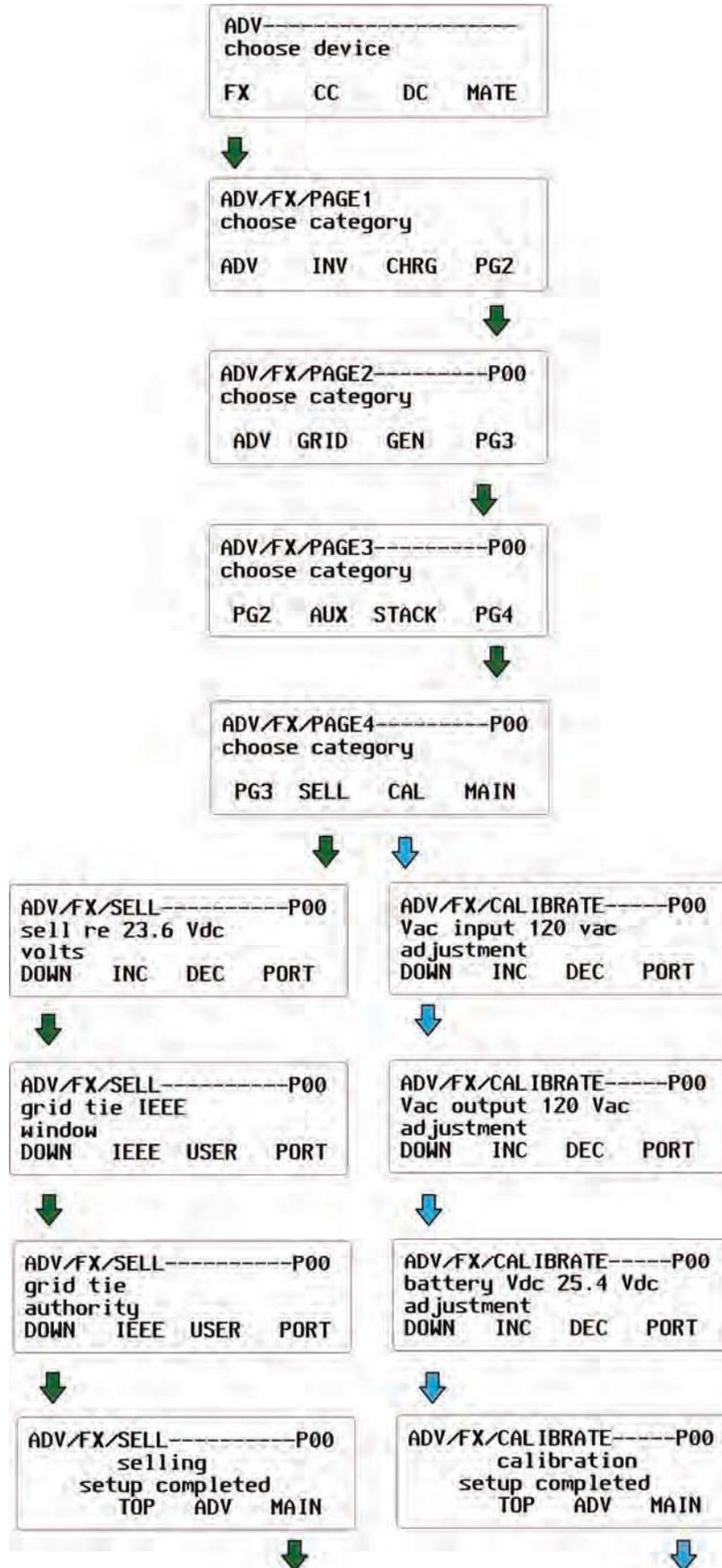
Figure 97 Schéma des menus ADV FX Setup (Page 4)
