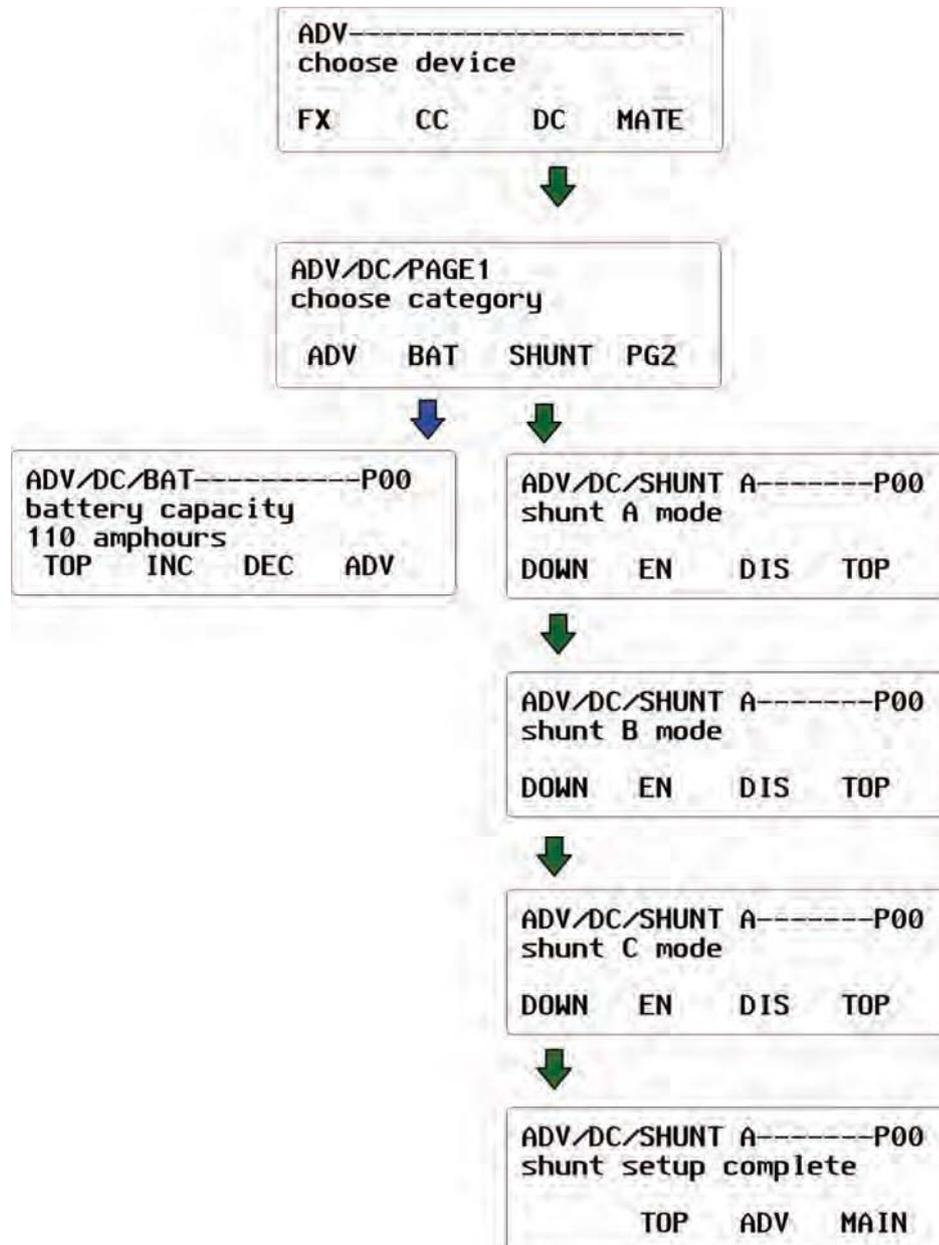
Figure 100 Schéma des menus ADV FNDC Setup (Page 1)
