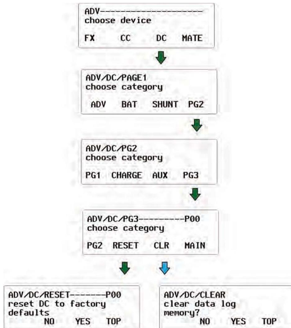
Figure 102 Schéma des menus ADV FNDC Setup (Page 3)
