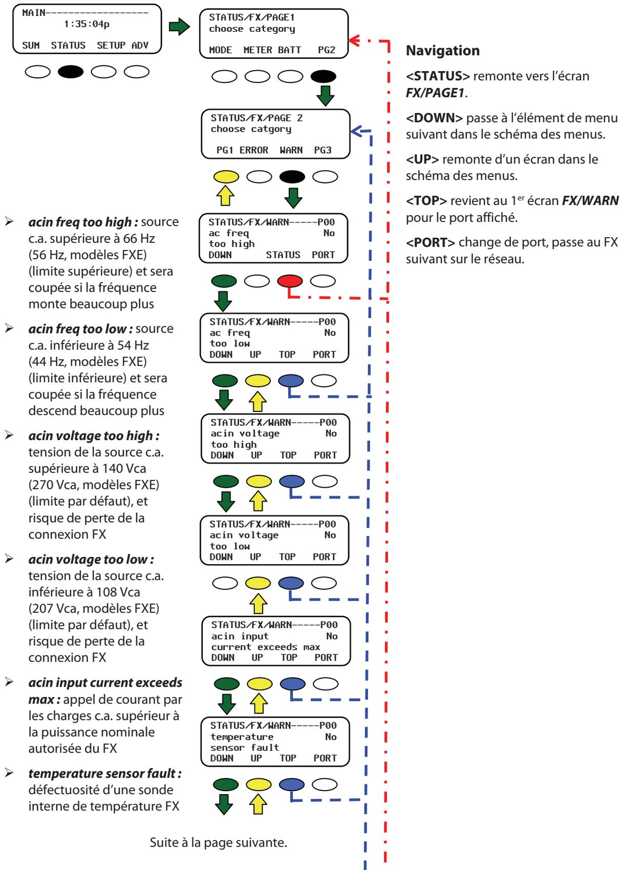
Figure 35 Écrans d'alertes WARN STATUS FX (première partie)
