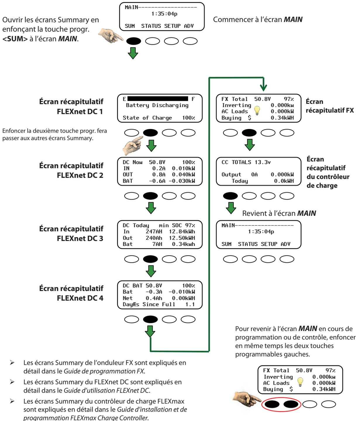
**Figure 29 Écrans Summary MATE (avec un FLEXnet DC)**
