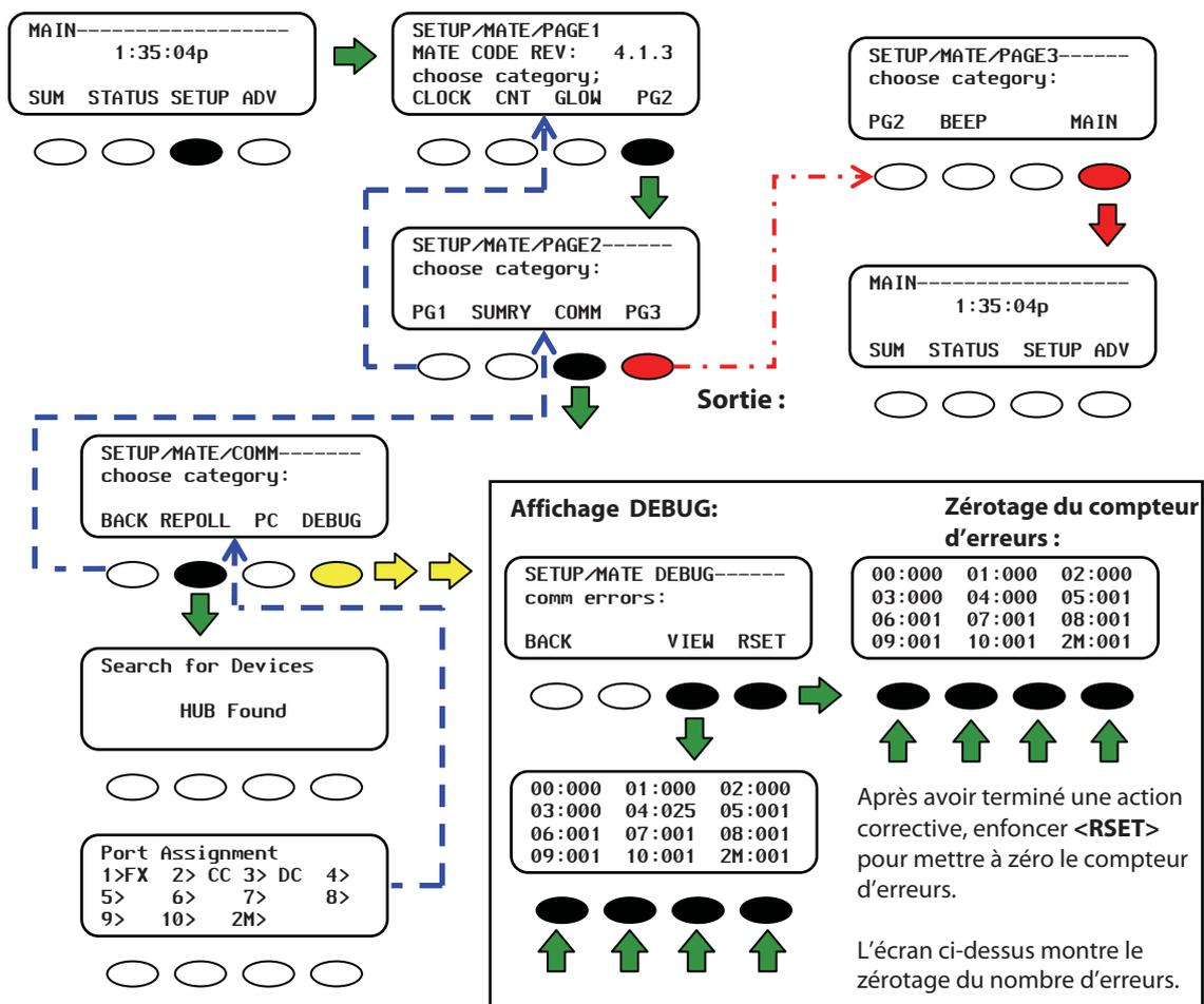
**Figure 79 Redétection par le système et affichage DEBUG**
