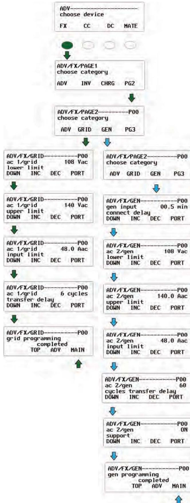
Figure 95 Schéma des menus ADV FX Setup (Page 2)
