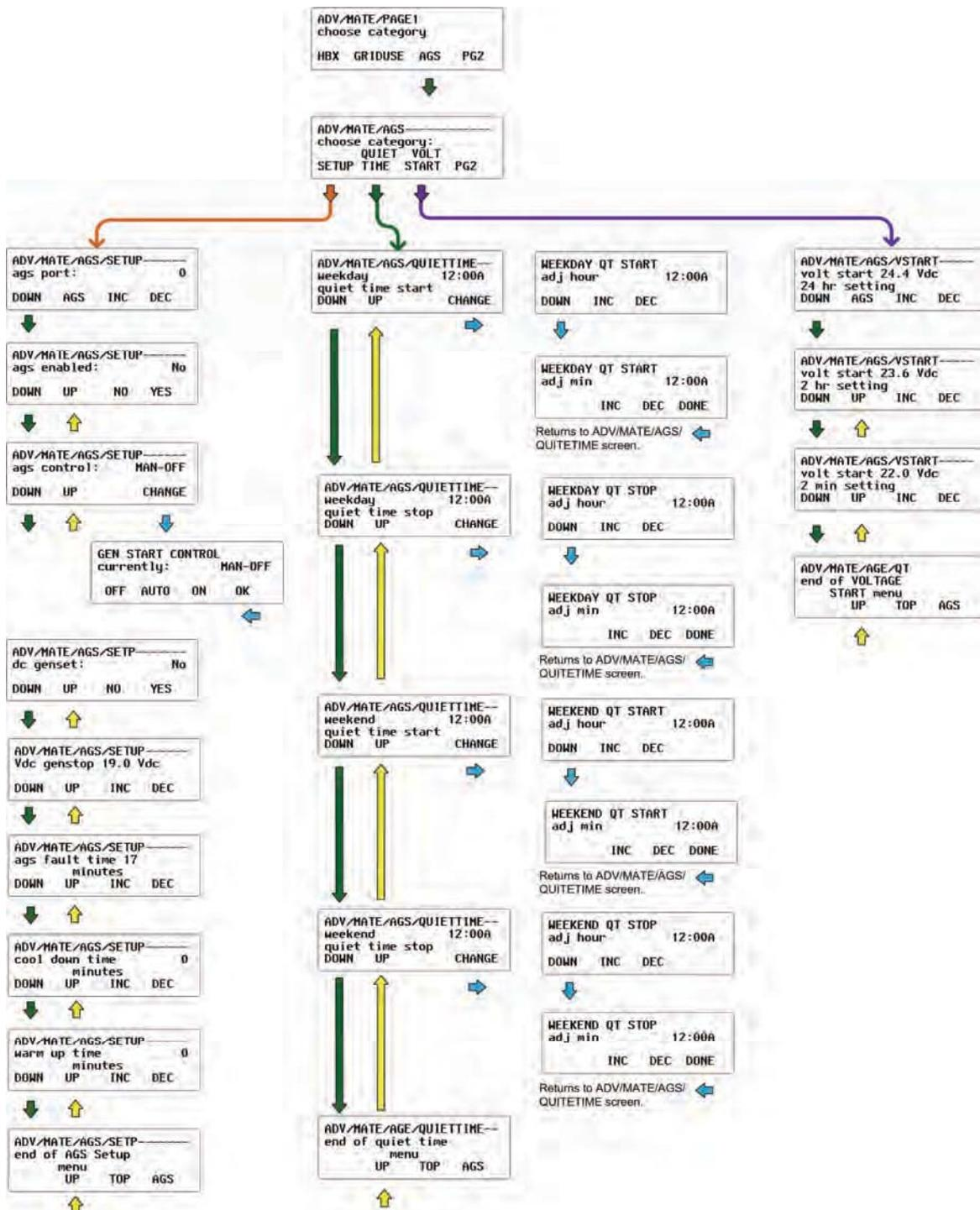
Figure 89 Schéma des menus ADV MATE SETUP (AGS Page 1)
