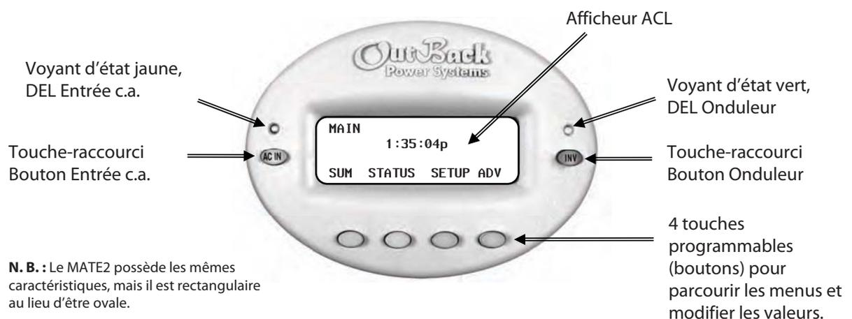
**Figure 1** Caractéristiques du MATE
