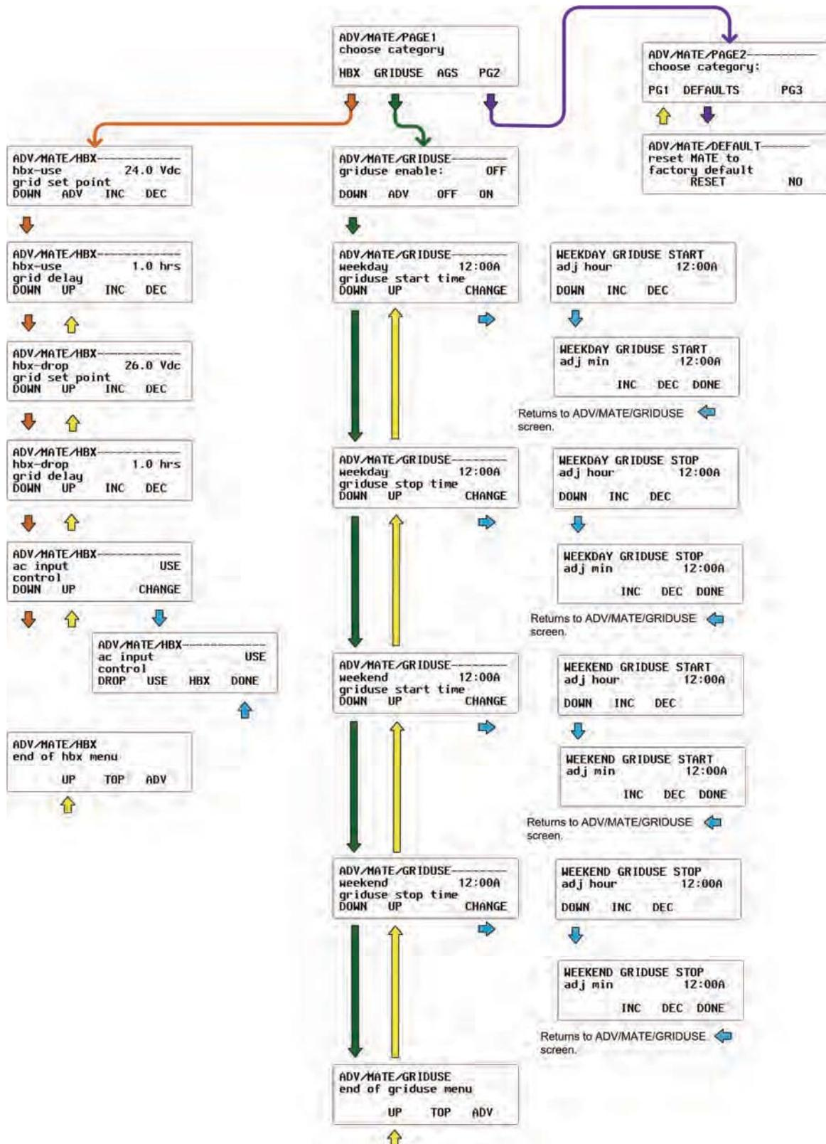
**Figure 88 Schéma des menus ADV MATE SETUP (HBX, Grid Use, et Reset Defaults)**
