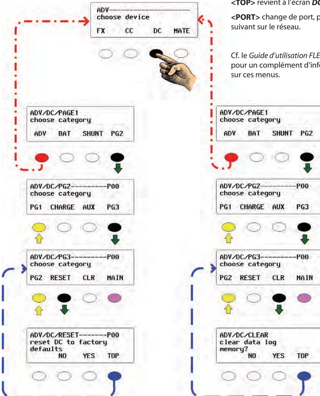
Figure 77 Menu ADV des fonctions FNDC Reset et CLEAR
