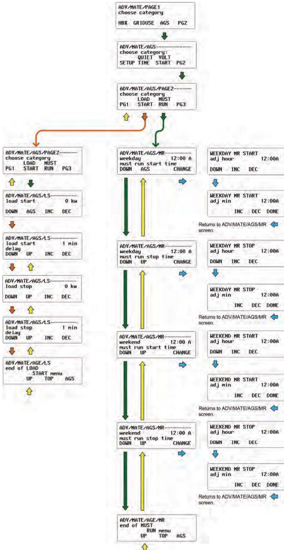
**Figure 90 Schéma des menus ADV MATE SETUP (AGS Page 2)**
