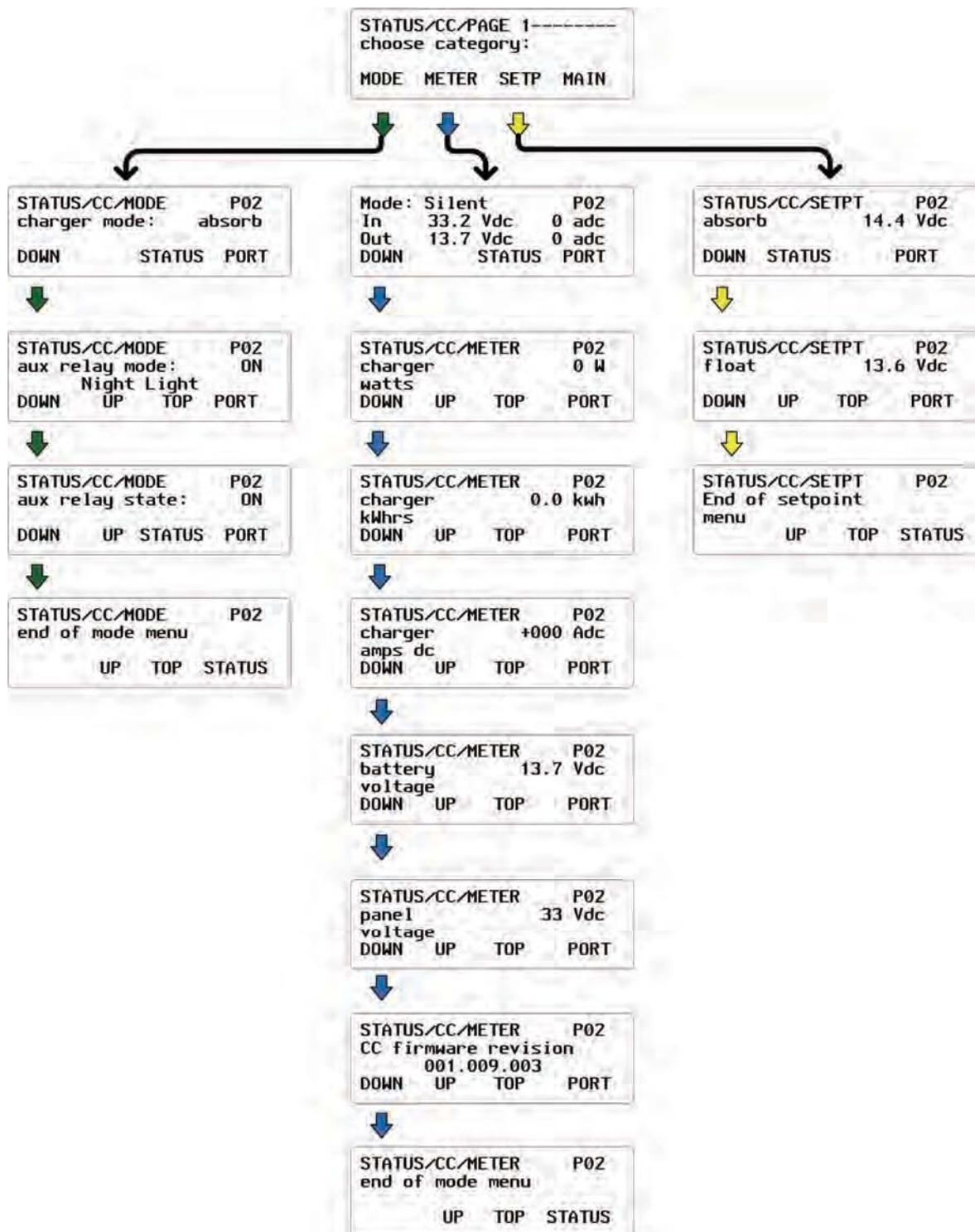
**Figure 84 Schéma des menus CC STATUS (contrôleur de charge)**
