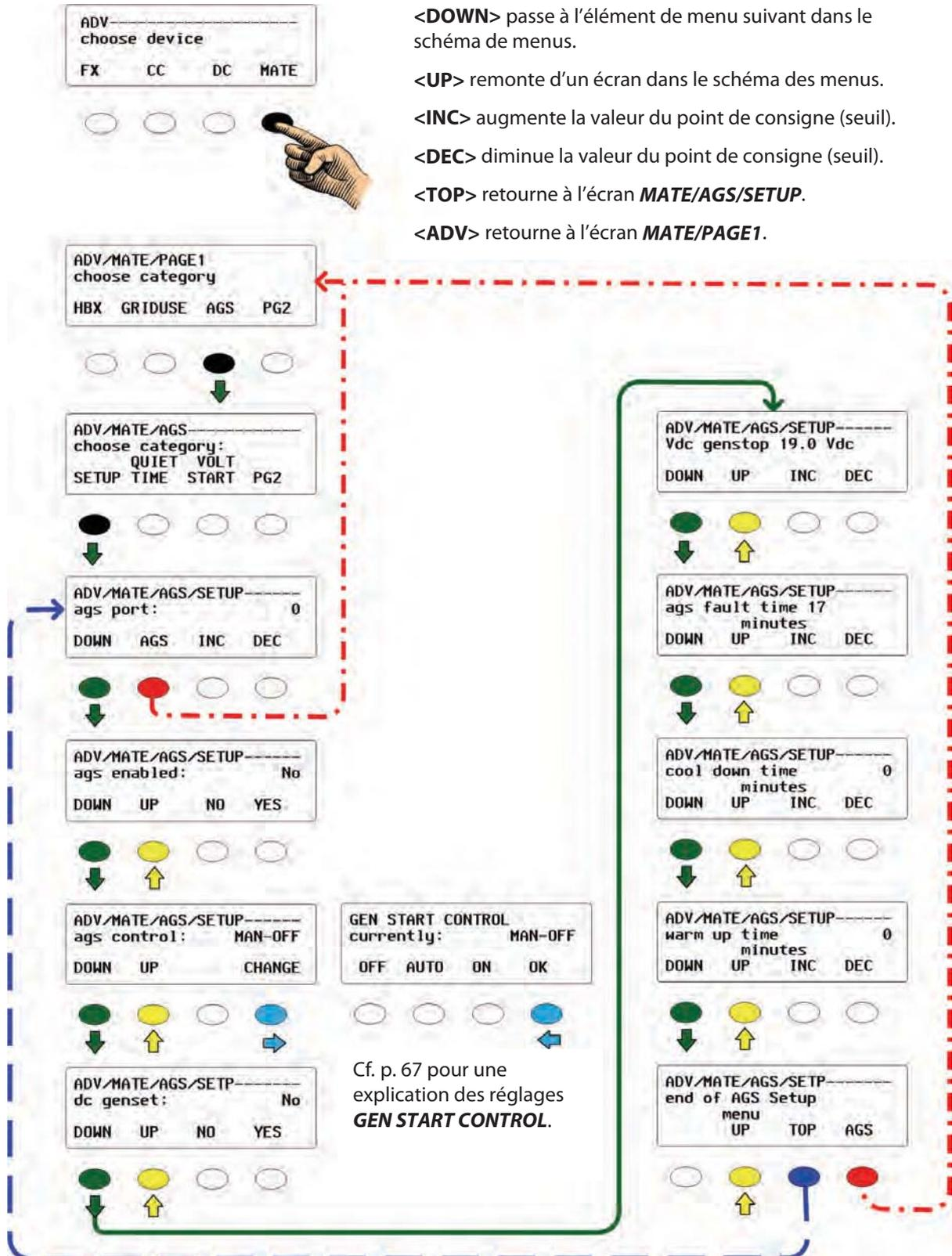
**Figure 51** Menus ADV pour le menu MATE AGS SETUP
