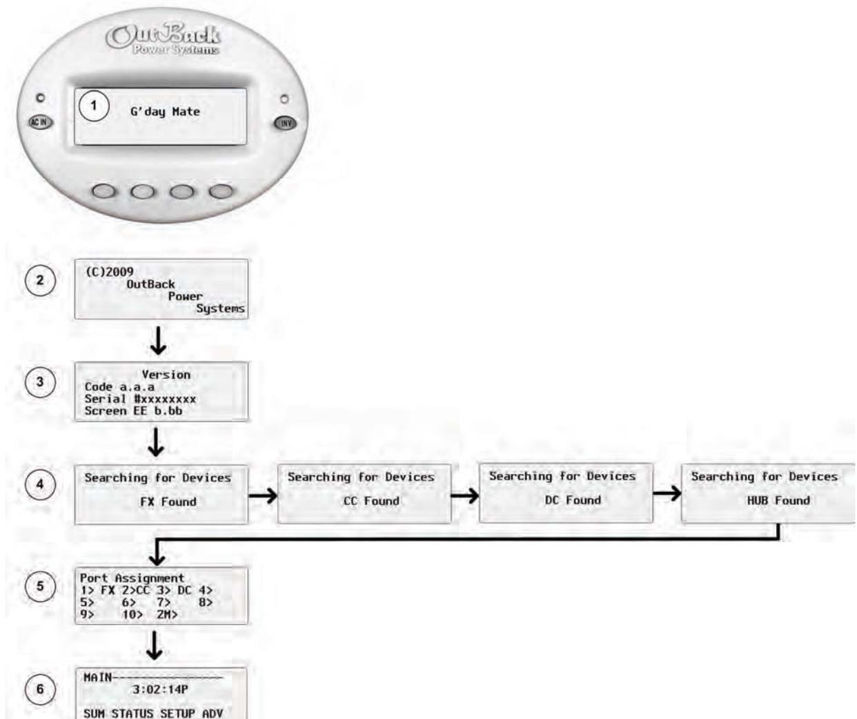
**Figure 24** Détection des appareils
