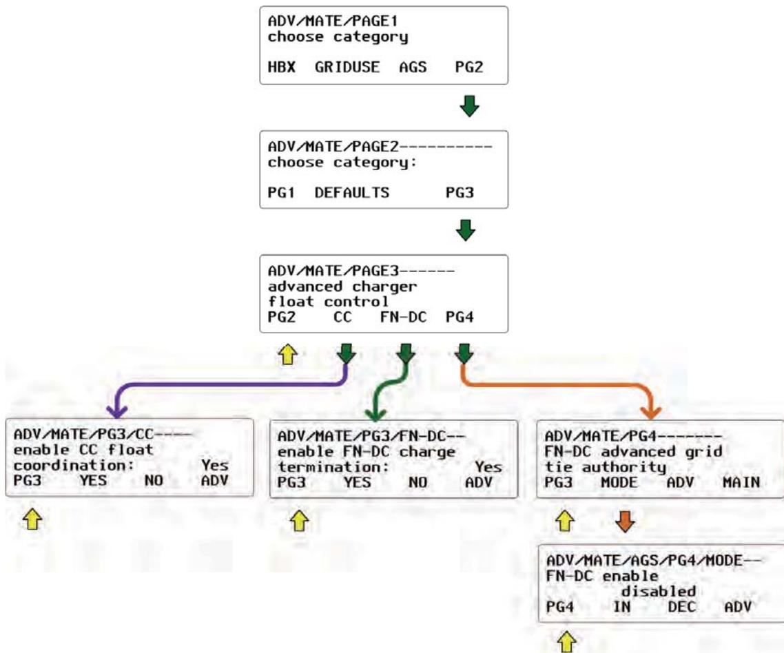
Figure 92 Schéma des menus ADV MATE SETUP (Page 3)
