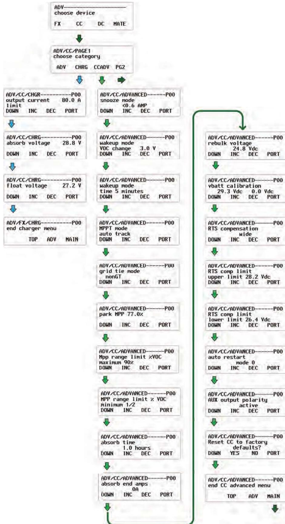
Figure 98 Schéma des menus ADV CC Setup (Page 1)
