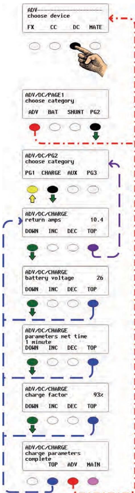
Figure 75 Menu ADV des fonctions de charge FNDC
