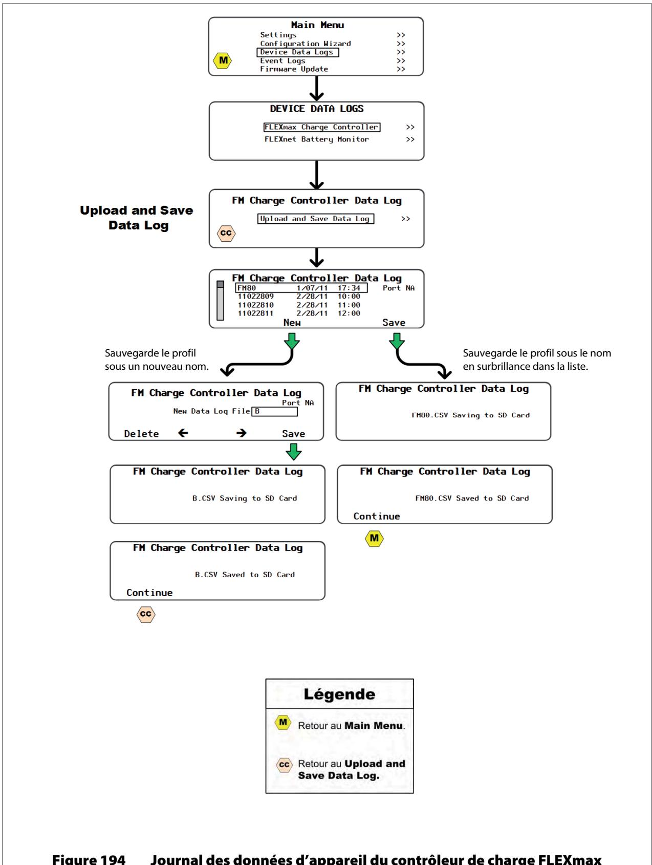
Figure 194 Journal des données d'appareil du contrôleur de charge FLEXmax
