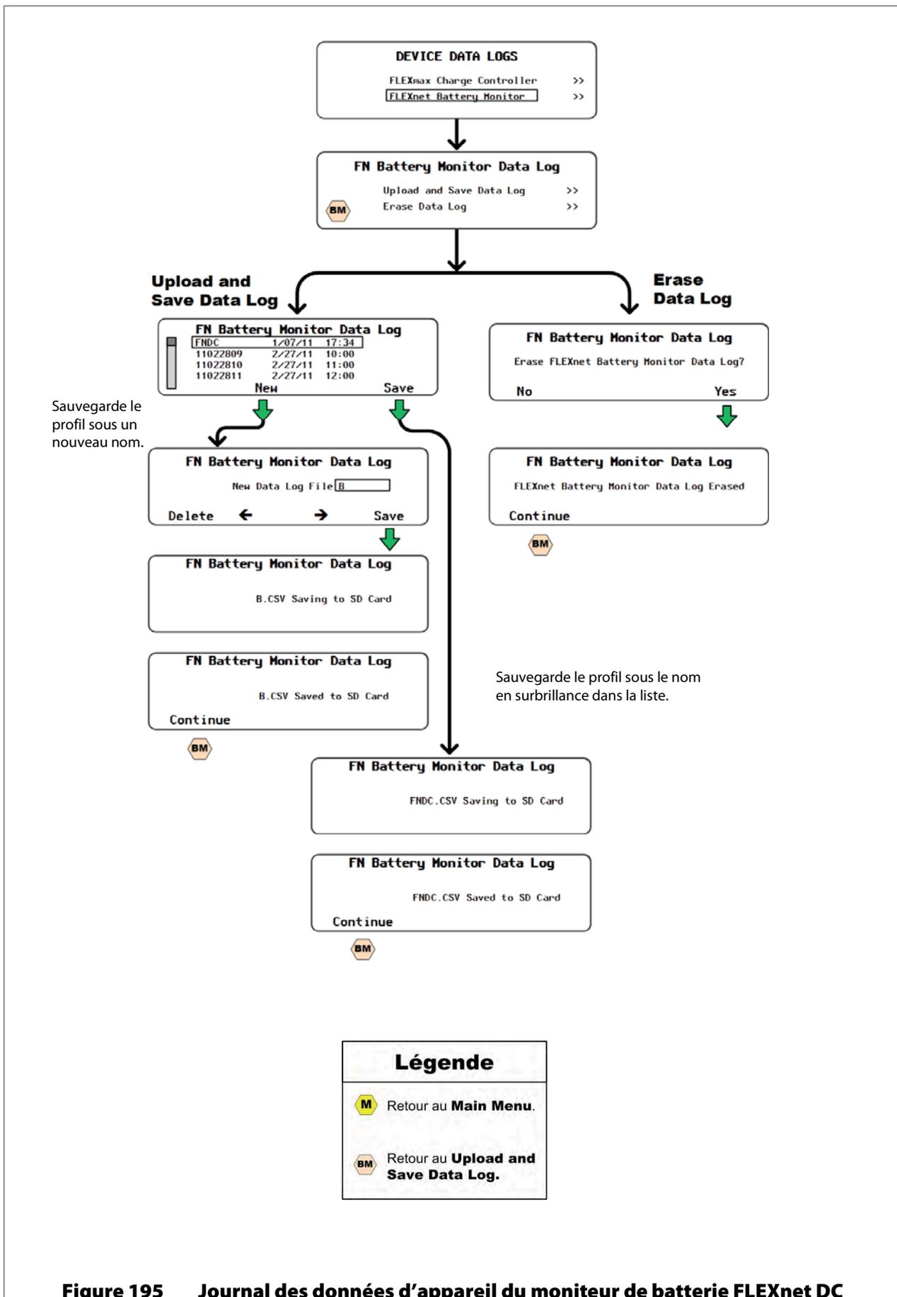
Figure 195 Journal des données d'appareil du moniteur de batterie FLEXnet DC
