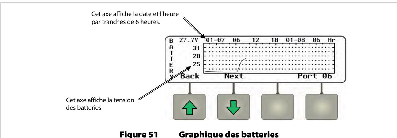
La touche programmable **<Next>** permet d'ouvrir un écran affichant les modifications de la tension PV au fil du temps.
