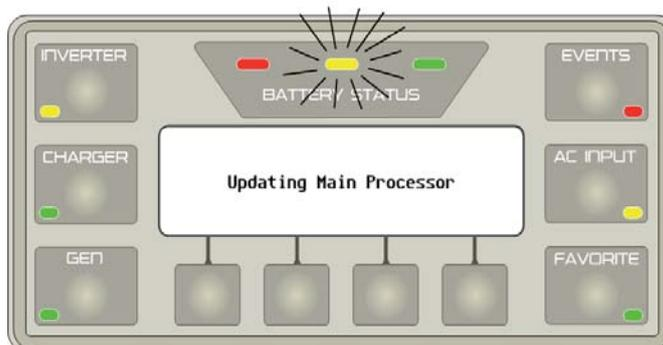
**Figure 179** Installation de la mise à jour du micro logiciel
