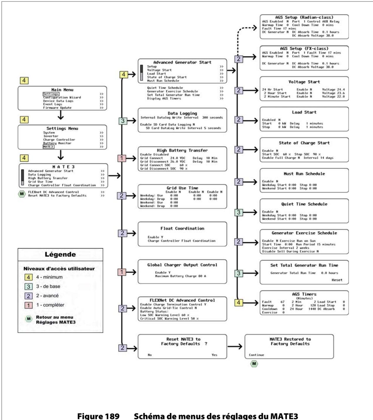
Figure 189 Schéma de menus des réglages du MATE3
