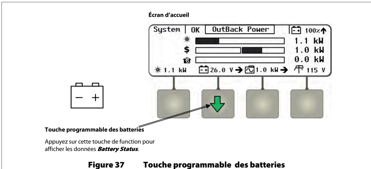
En l'absence d'un moniteur de batterie FLEXnet DC sur le système, la touche programmable des batteries permet d'ouvrir les écrans suivants.
