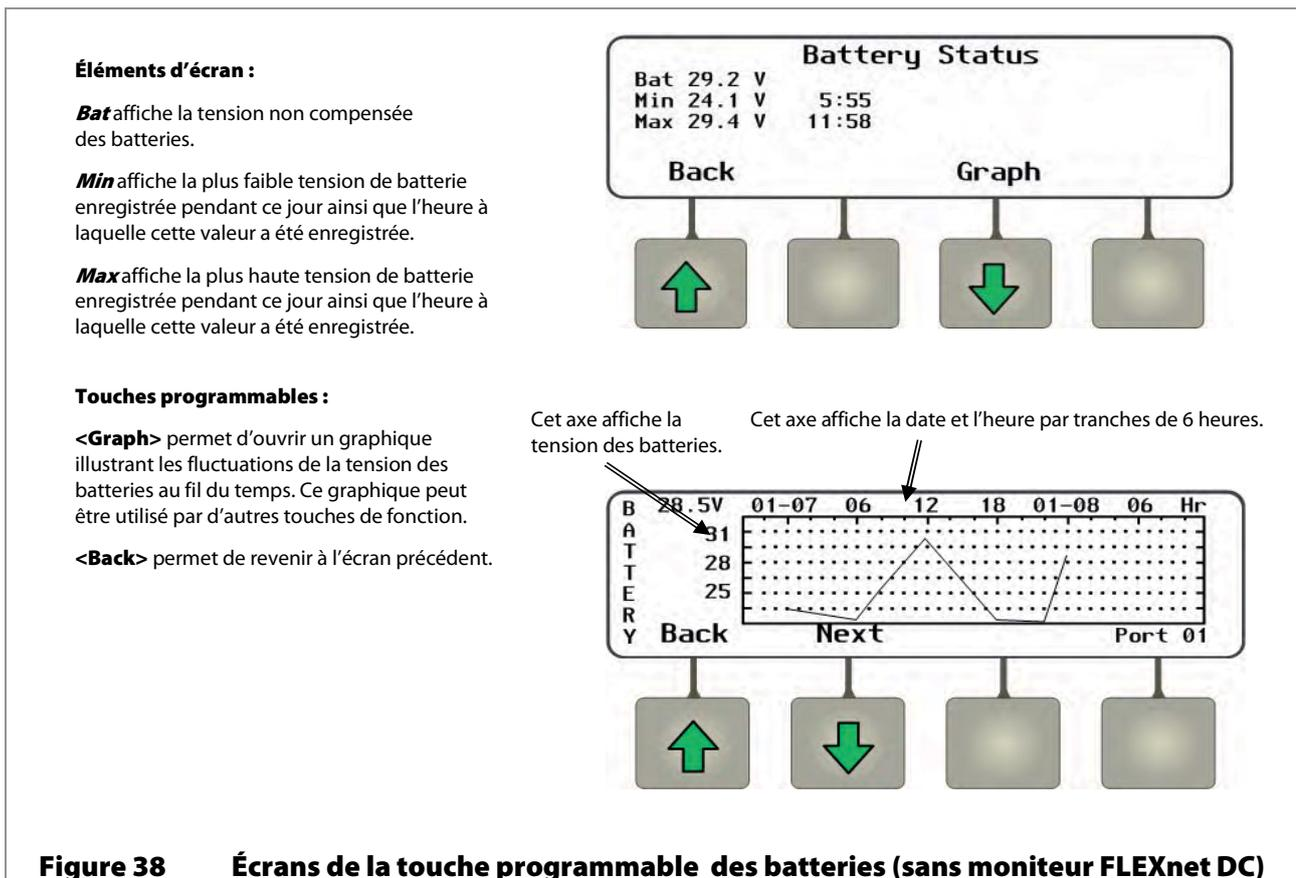
En présence d'un moniteur FLEXnet DC sur le système, la touche programmable des batteries permet d'ouvrir les écrans suivants.
