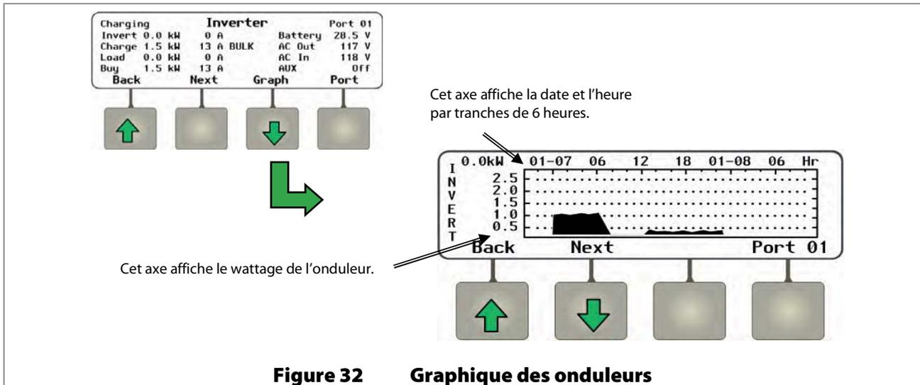
La touche programmable **<Next>** permet d'ouvrir un écran qui affiche les modifications de la puissance en watts produit par le chargeur des batteries au fil du temps.
