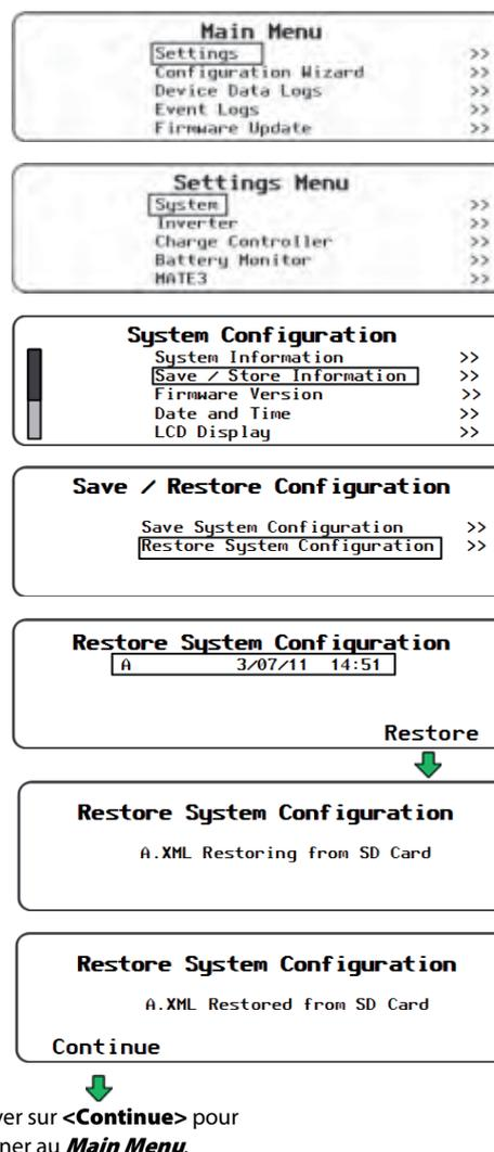
**Figure 76 Restauration de la configuration du système**
