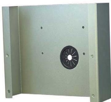
La trousse de montage en surface du MATE3 (FW-MB3-S) sert à monter le MATE3 sur une surface plane, sans avoir à percer de trou dans cette surface pour acheminer le câble CAT5. Elle consiste en un support qui laisse suffisamment d'espace entre le MATE3 et la surface pour le passage du câble CAT5.
