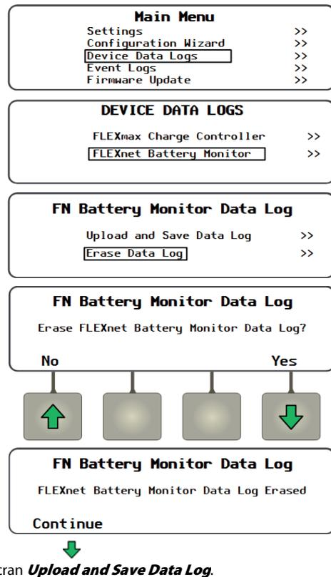
**Figure 170** Suppression d'un journal des données du moniteur de batterie FLEXnet DC
