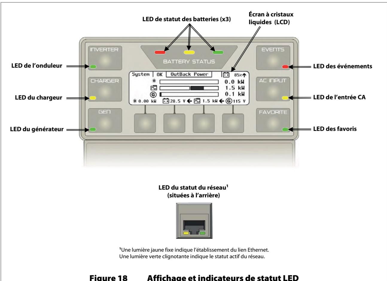
**Figure 18 Affichage et indicateurs de statut LED**
