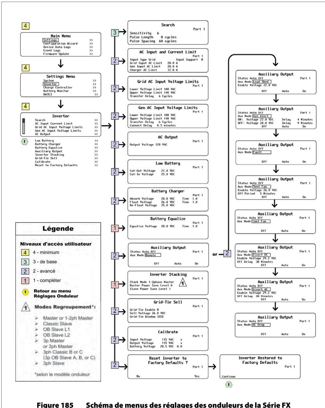
Figure 185 Schéma de menus des réglages des onduleurs de la Série FX
