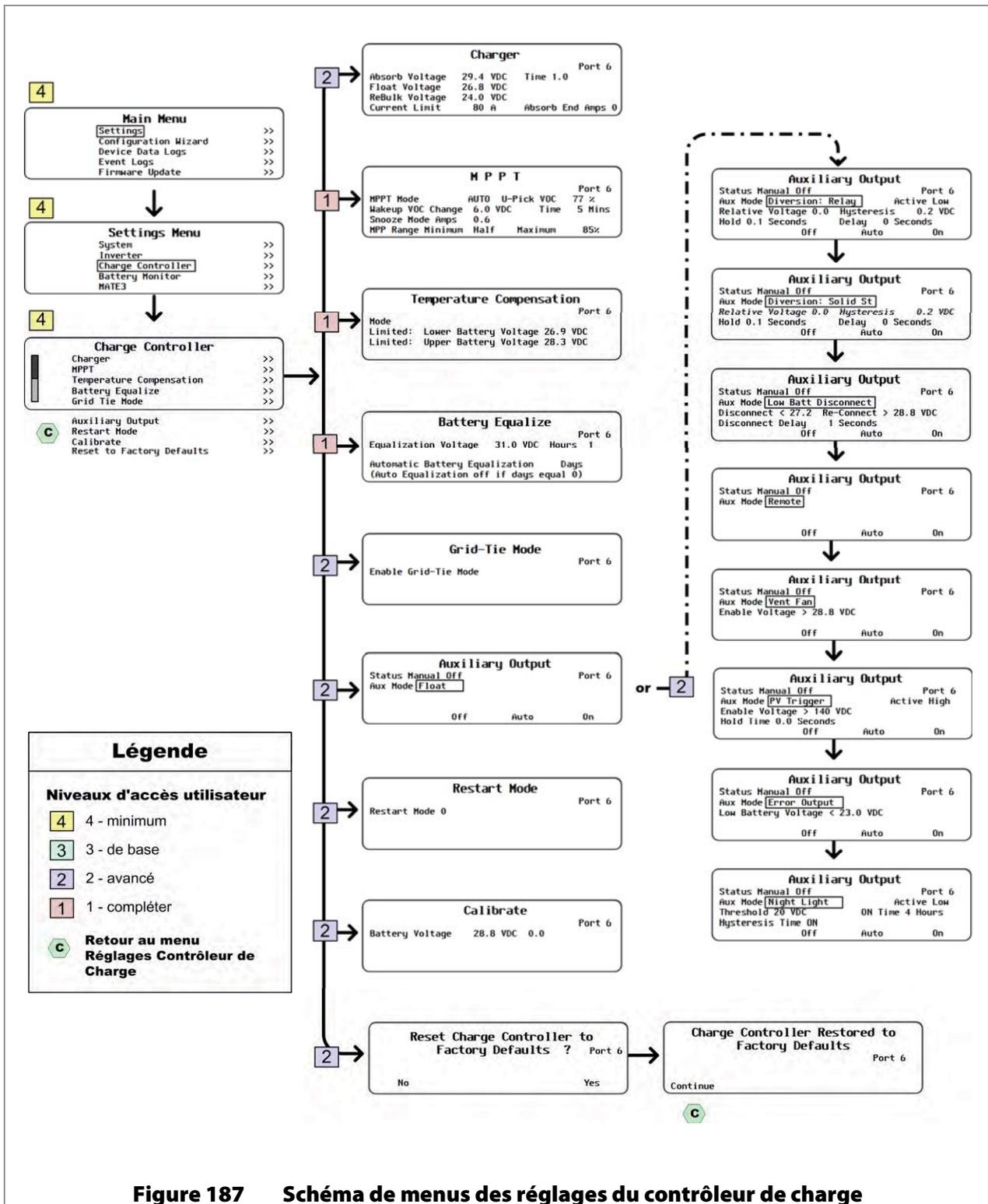
Figure 187 Schéma de menus des réglages du contrôleur de charge
