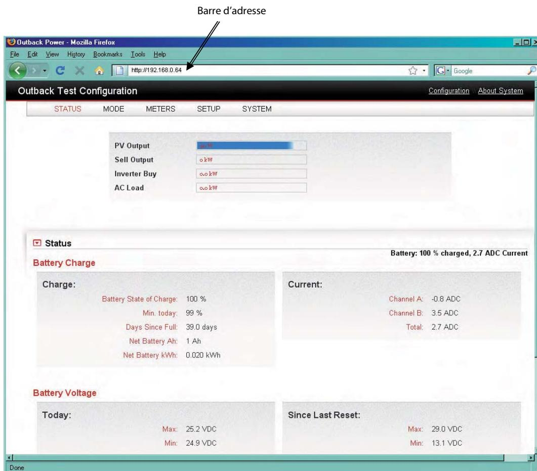
Figure 14 Accès direct au MATE3 à partir d'un ordinateur
