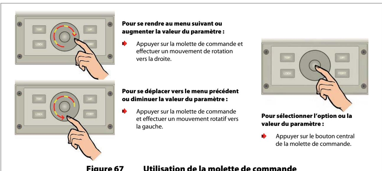
**Figure 67 Utilisation de la molette de commande**
