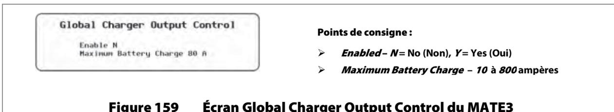
**Figure 159** Écran Global Charger Output Control du MATE3
