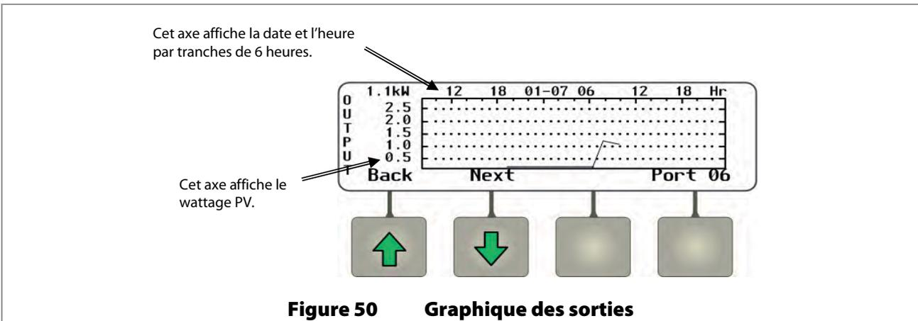
La touche programmable **<Next>** permet d'ouvrir un écran affichant les modifications de la tension des batteries au fil du temps. Ce graphique peut être utilisé par d'autres touches programmables.
