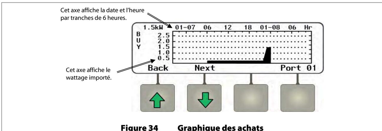
La touche programmable **<Next>** permet d'ouvrir un écran qui affiche les modifications de la puissance en watts vendu au courant secteur par un système réseau-interactif au fil du temps.
