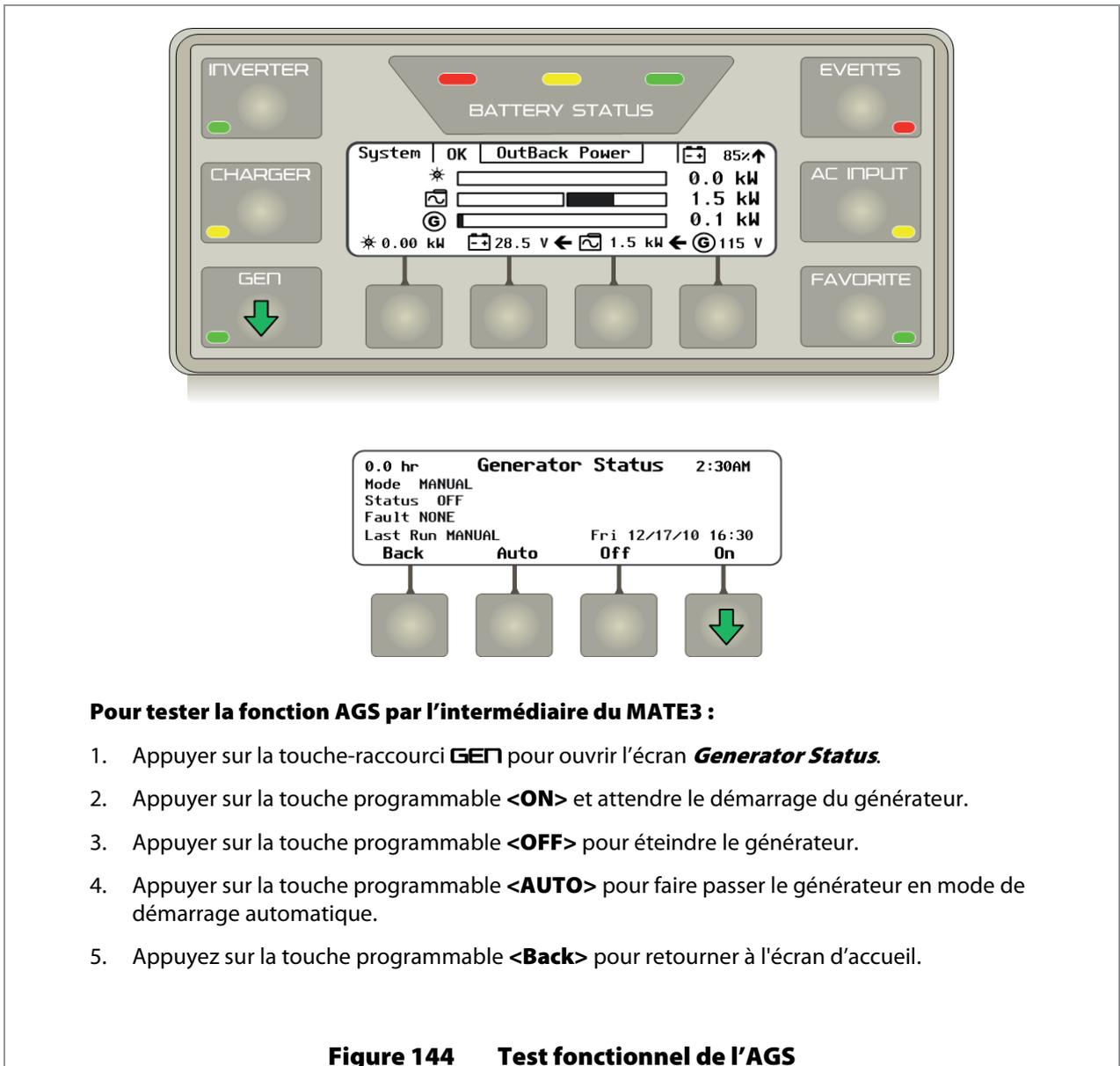
Le test de l'AGS sert à confirmer le bon fonctionnement de la fonction AGS ainsi que celui du générateur lors de la programmation de l'AGS.
