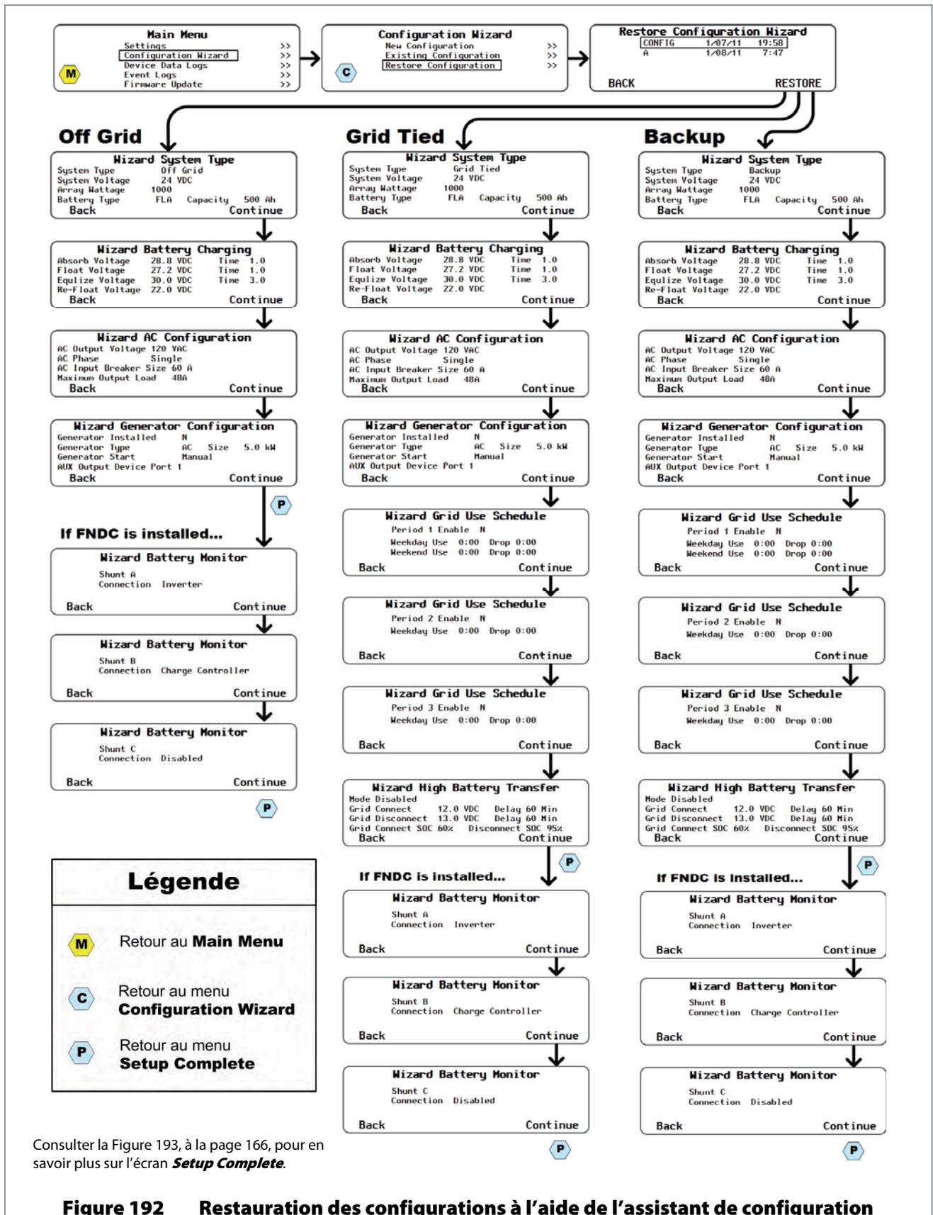
**Figure 192 Restauration des configurations à l'aide de l'assistant de configuration**
