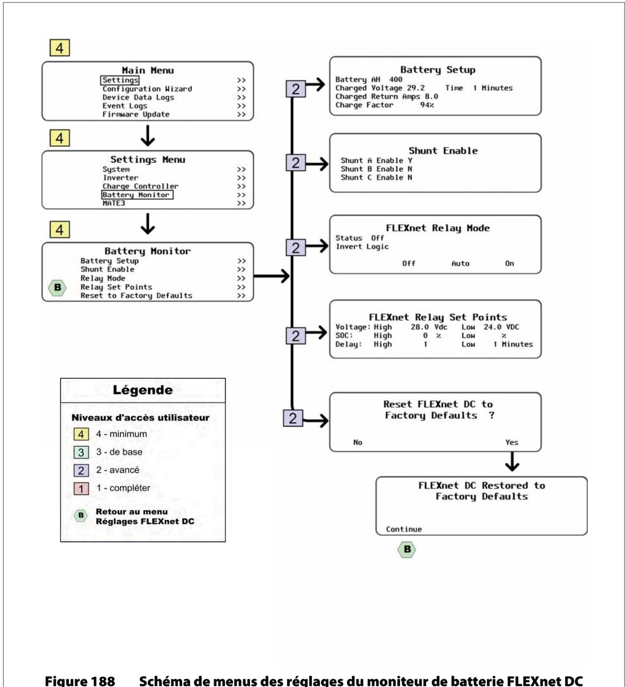
Figure 188 Schéma de menus des réglages du moniteur de batterie FLEXnet DC
