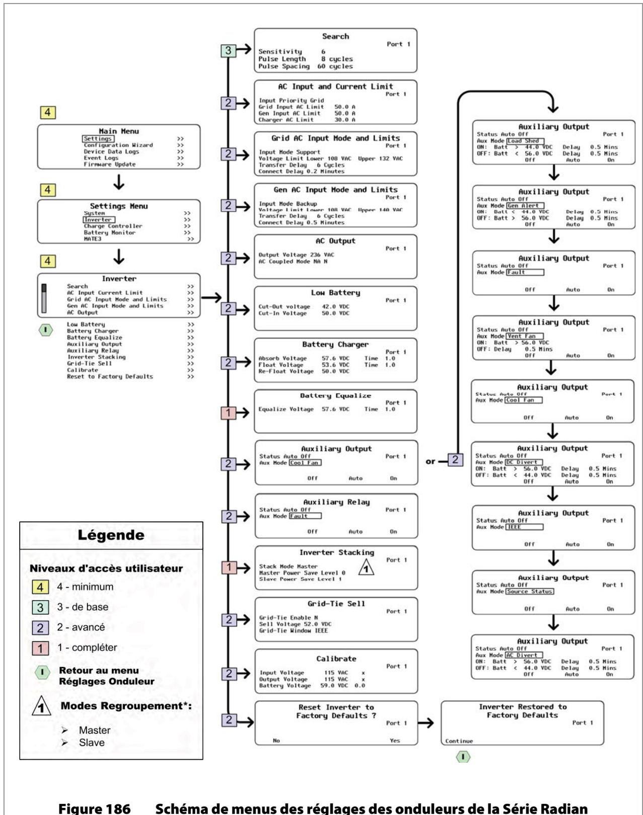
Figure 186 Schéma de menus des réglages des onduleurs de la Série Radian
