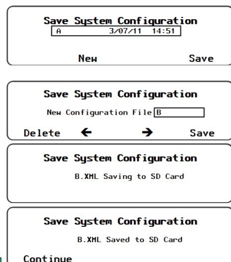
**Figure 75** Sauvegarde d'une configuration sur une carte SD
