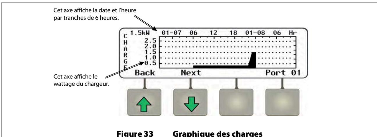
La touche programmable **<Next>** permet d'ouvrir un écran qui affiche les modifications de la puissance en watts importé (acheté) par le système d'onduleurs d'une source CA au fil du temps.
