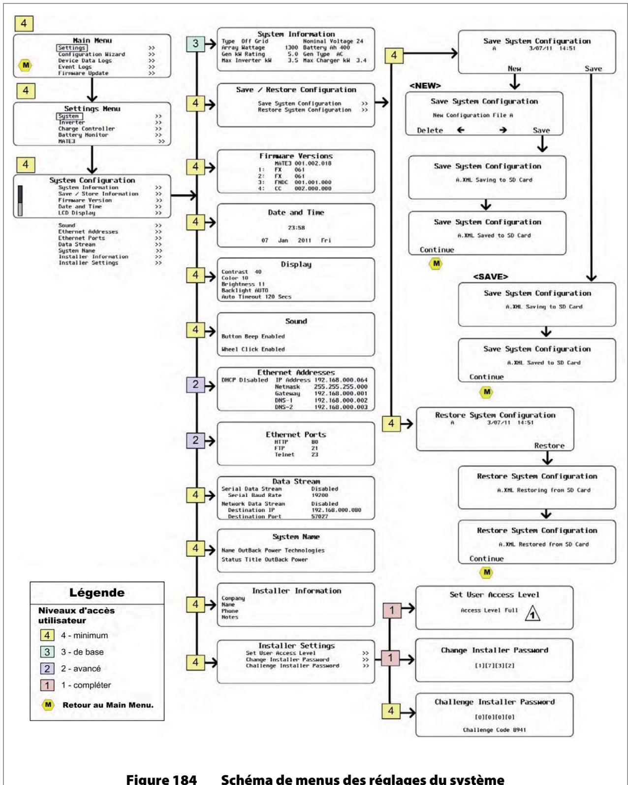
Figure 184 Schéma de menus des réglages du système
