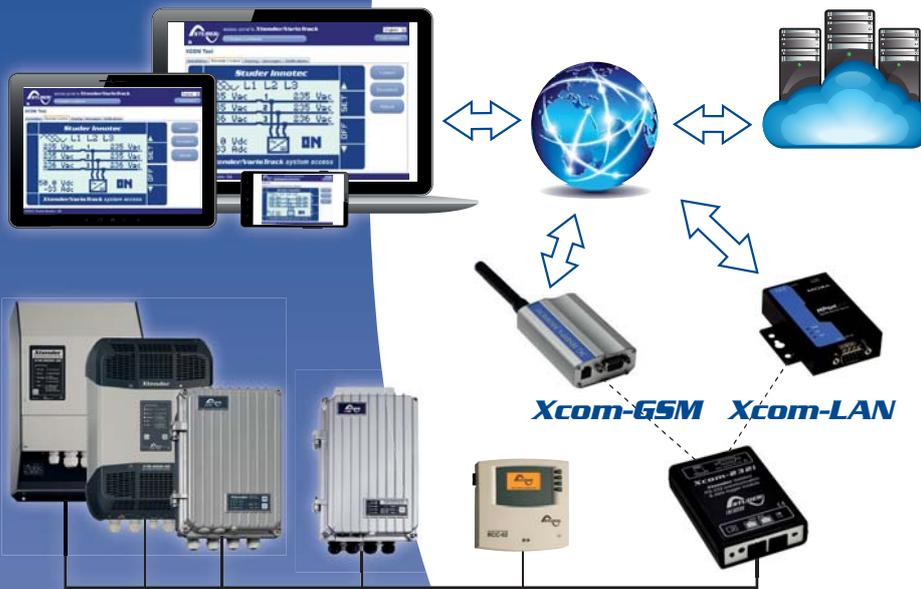
Studer Innotec propose une solution «clé-en-main» via un serveur sécurisé et une interface simple et conviviale, permettant le contrôle d'une ou plusieurs installations. L'interface permet d'interagir à distance avec l'installation exactement comme avec la télécommande RCC-02/-03 sur site, à savoir : accès à tous les paramètres et visualisation en temps réel des valeurs mesurées sur les appareils du système.
