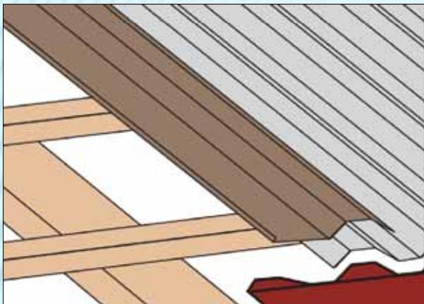
Le Sol étanche long permet le raccordement longitudinal avec le bac et la toiture existante. Il peut avoir de une à trois ondulation selon la largeur du champ photovoltaïque.
