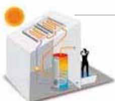
En fonctionnement, l'échangeur du ballon sert de vase d'expansion car l'air contenu dans le circuit est amené dans les premières spires de l'échangeur.
