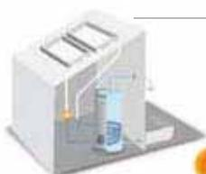
A l'arrêt, quelque soit la situation, panne d'alimentation électrique, nuit, mise en sécurité de température haute, grâce au drainage, les capteurs et tuyauteries sont vides de fluide, le système est en sécurité passive, sécurité optimale.
