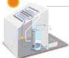
Lorsque la régulation enregistre une température dans les capteurs supérieure à la température de l'eau du ballon, elle enclenche la pompe qui envoie le fluide caloporteur dans les capteurs afin d'en extraire les calories solaires.
