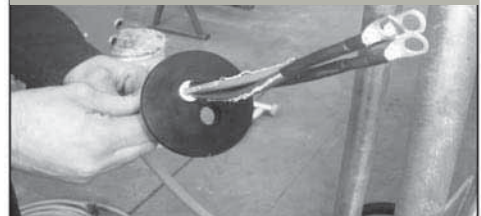
Extrémités du câble inférieur (sortie du générateur) insérées dans le chapeau. L'autre trou sert pour le câble de frein
