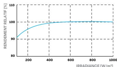
Puissance de modules typique sous des conditions de rayonnements faibles par rapport aux conditions STC (25°C, 1000 W/m<sup>2</sup>).
