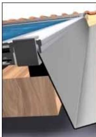
En outre, pour permettre la mise en place des abergements droits, le cadre doit être positionné au milieu du crochet pour dégager la rainure.
