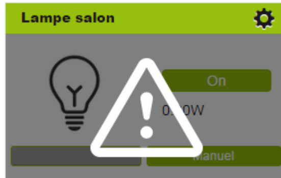
Figure 14 : exemple de notification d'absence de communication avec un appareil
