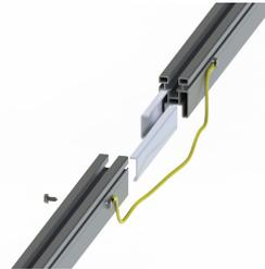
Pose des vis à tête hexagonale de 4,8 x 13 mm de chaque côté du rail à 105 mm de l'extrémité de chaque rail inférieur (butée).
